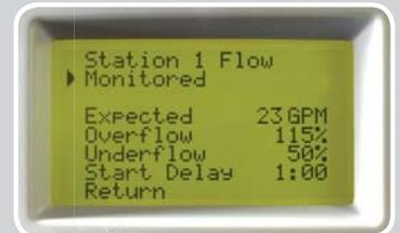
Durchflussüberwachung und -steuerung per Tastendruck – für jede Station einzeln programmierbar.
